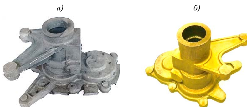
Рис. 2. Отливки «Корпус» из сплавов МЛ10 (а) и МЛ5пч (б)
